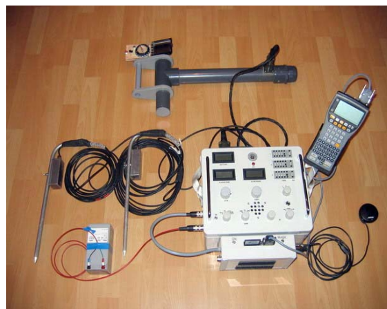
Appareillage géophysique électromagnétique pouvant travailler en mode RMT, RF-EM et VLF-EM GRAD
